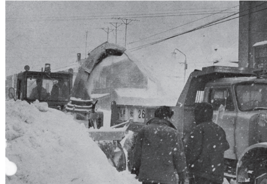
▲写真：ロータリー除雪車とダンプカーでの排雪作業（「広報よいち」昭和45年3月号）
